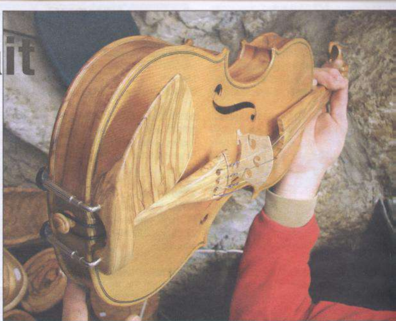
A l'exception de la table et de la barre d'harmonie, en épicea, ainsi que du chevalet en érable, toutes les pièces du violon de Guillaume Dubosq sont en bois d'olivier.
